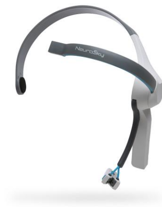
Figura 2: Dispositivo de medida de la actividad cerebral de bajo coste.
