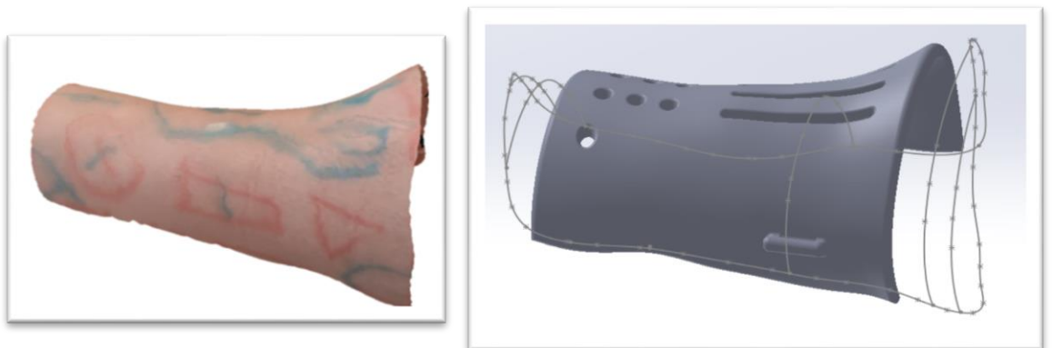
Figura 13: Prótesis diseñada en el ordenador tomando como molde el modelo 3D generado previamente.
