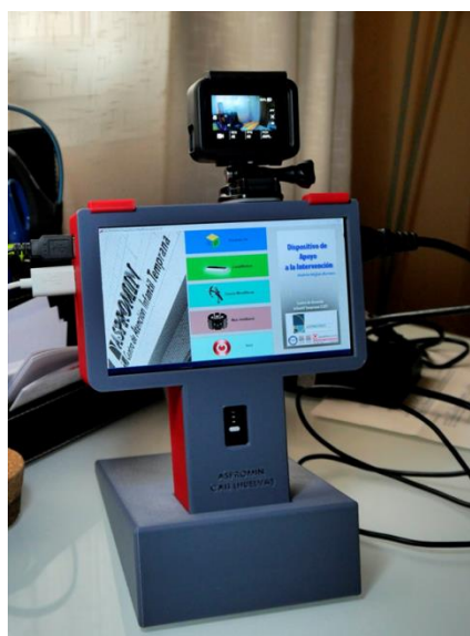
Figura 9: Escáner 3D desarrollado en Aspromin.
